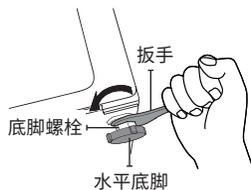
2. 调整水平底脚直到所需的高度。向左旋转为调高底脚, 向右旋转则为调低底脚。
