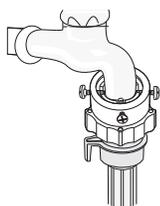
4.重新将进水管连接到水龙头上，检查进水和排水是否正常。
